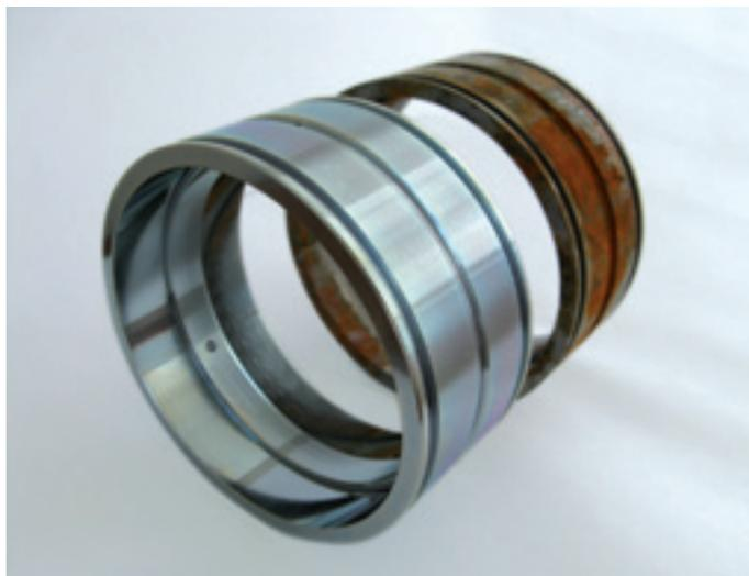
На обработанном покрытием крае (передний) не обнаружено никаких видимых следов коррозии после нескольких часов испытаний на стойкость к соляному туману. Необработанная часть (задняя) покрылась ржавчиной.
